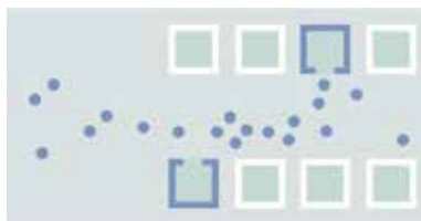
1 et 2 - Les usagers rentrent leur étage de destination en utilisant des écrans tactiles, et reçoivent instantanément la désignation de la cabine qui leur est affectée.
